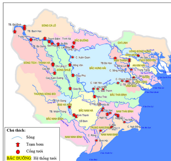
Hình 7. Các công trình chính lấy nước
